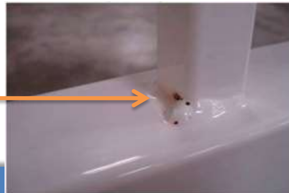
Soudure irrégulière et poreuse Après thermolaquage
